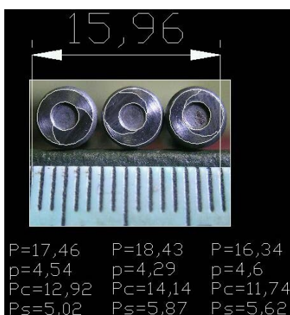
Rys. 2. Wygląd przykładowych powierzchni próbek po cyklu badawczym (100000 obrotów) i sposób określenia pola powierzchni śladu współpracy
