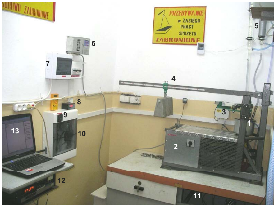
Rys. 1. Stosowane w opisywanych badaniach stanowisko do określania własności smarnych i odporności materiałów na zużycie. 1 - osłona węzła trącego, 2 - podstawa i układ napędowy maszyny trącej, 3 - układ pomiarowy momentu tarcia, 4 - dźwignia obciążająca, 5 - układ stabilizacji temperatury badanego czynnika smarnego, 6 - falownik, 7 - zabezpieczenia elektryczne, 8 - termometr i regulator temperatury czynnika smarnego, 9 - licznik cykli, 10 - zespół wzmacniaczy, karta pomiarowa, układy sterowania i zabezpieczeń progowych, 11 - układ cyrkulacji i filtracji czynnika smarnego, 12 - wskaźnik momentu tarcia, 13 - komputer rejestrujący wyniki
